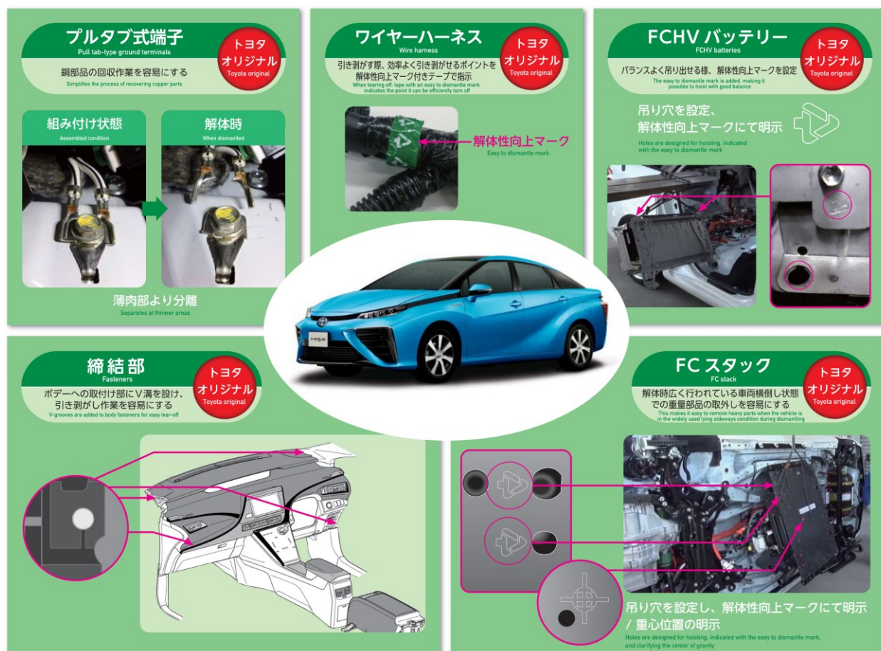
図－1 構造の工夫・易解体設計
